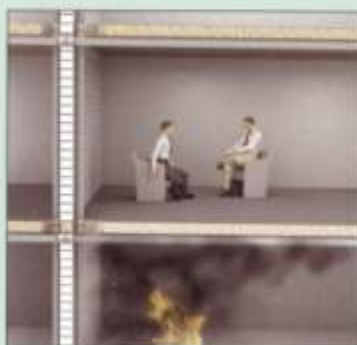
1. В изолированном помещении начался пожар.
